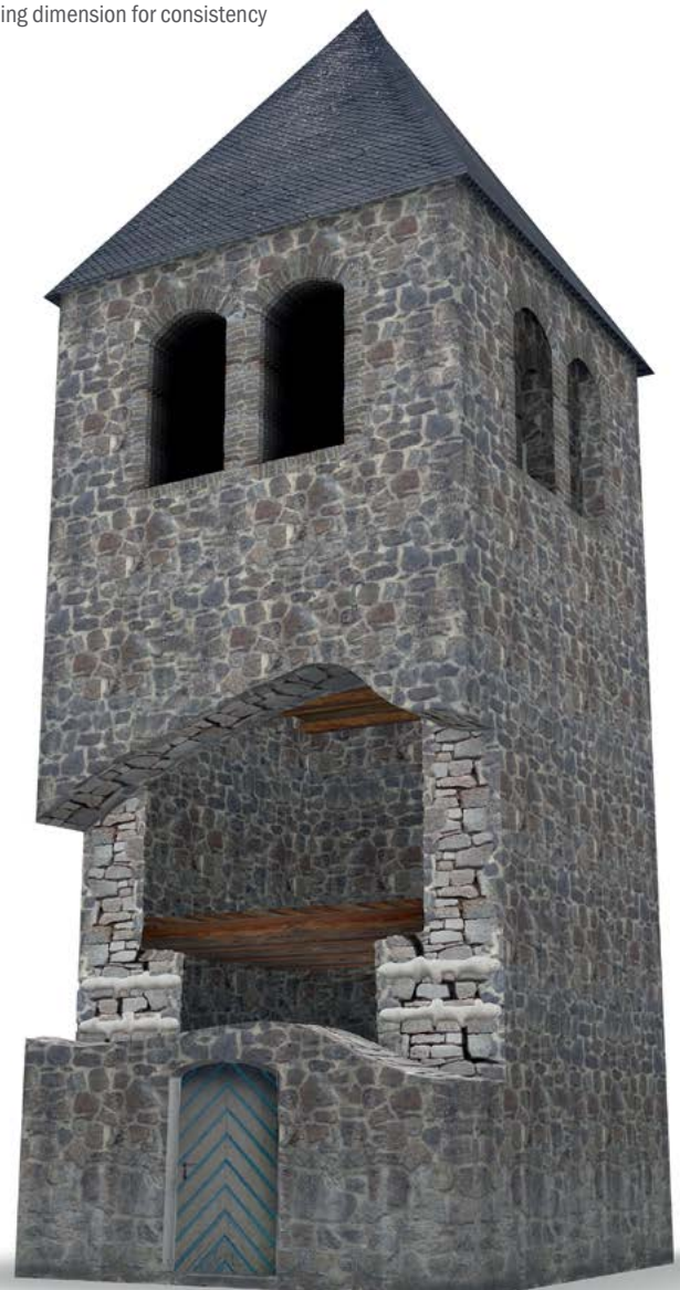
Verbindung abgelöster Mauerwerkschalen Connection of separated wythes
