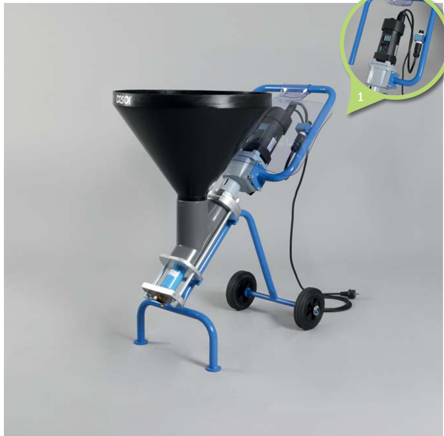
1. Stufenlose Fördermengenregulierung | Infinitely variable delivery rate regulation
