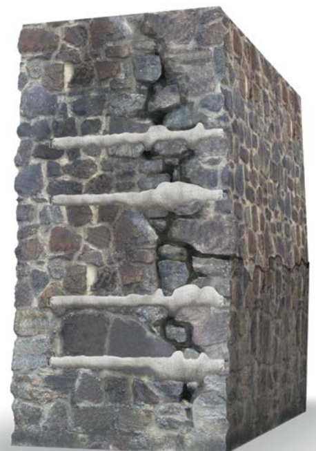
Anbindung abgelöster Mauerwerkschalen Connection of separated wythes
