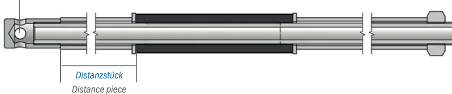
Endstück mit Querbohrung Ø 5 mm (4 x 90° versetzt) | End piece with cross boreholes Ø 5 mm (4 x 90° offset)
