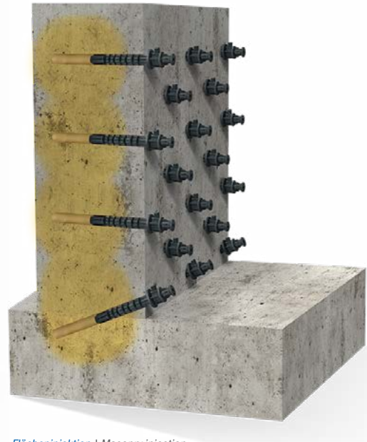
Flächeninjektion | Masonry injection
