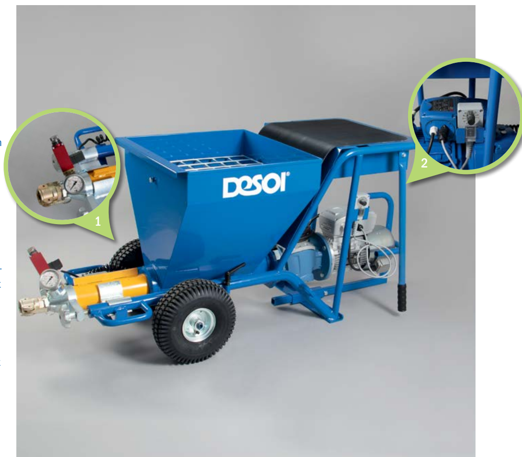
1. Druckschalter mit Manometer | Manometric switch with manometer
