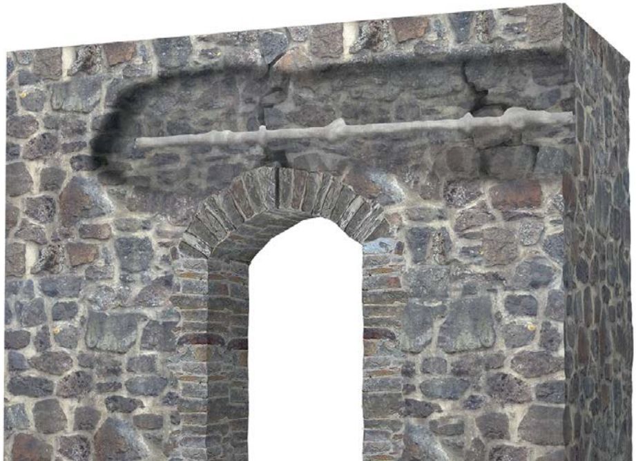
Sicherung gerissener Bauteile | Securing of cracked structural elements
