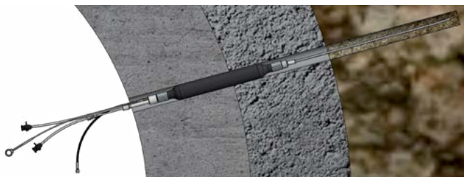
Gespannter Blähpacker mit Entlüftung vor der Injektion Clamped inflatable packer with ventilation before injection
