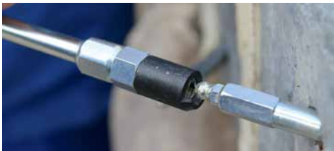
DESOI Snappy auf den Kegelnippel schieben, Sicherungssteg unten
